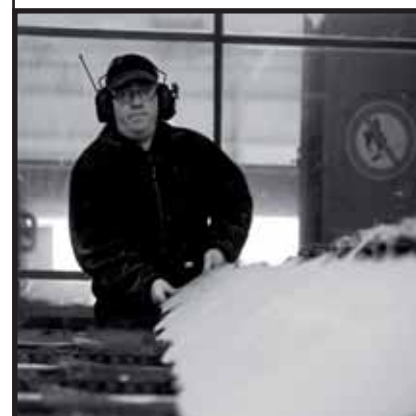
Passage à la déligneuse, machine à bois permettant de scier plusieurs planches ou madriers dans un même tronc. Ensuite, les débits passent par un trimmer où ils sont recoupés et triés.
