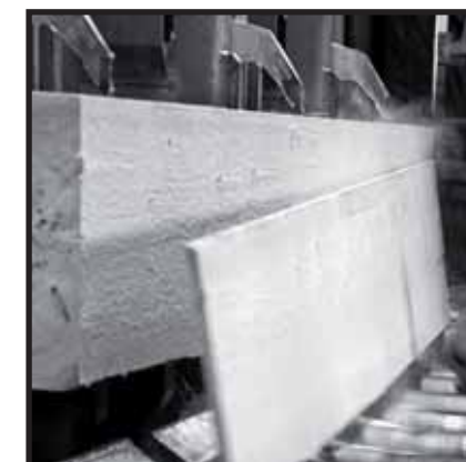
Passage à la déligneuse, machine à bois permettant de scier plusieurs planches ou madriers dans un même tronc. Ensuite, les débits passent par un trimmer où ils sont recoupés et triés.
