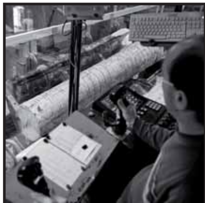
Opérateurs sur machines à commande numérique. À droite, le scieur débite les produits selon les commandes, les diamètres, la qualité du bois. Travail moins physique qu'avant mais qui demande une grande attention.
