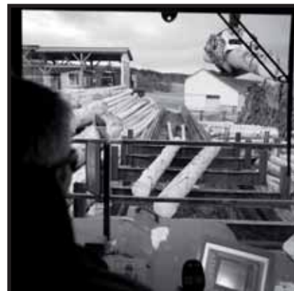
Opérateurs sur machines à commande numérique. À droite, le scieur débite les produits selon les commandes, les diamètres, la qualité du bois. Travail moins physique qu'avant mais qui demande une grande attention.
