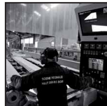
Passage à la déligneuse, machine à bois permettant de scier plusieurs planches ou madriers dans un même tronc. Ensuite, les débits passent par un trimmer où ils sont recoupés et triés.
