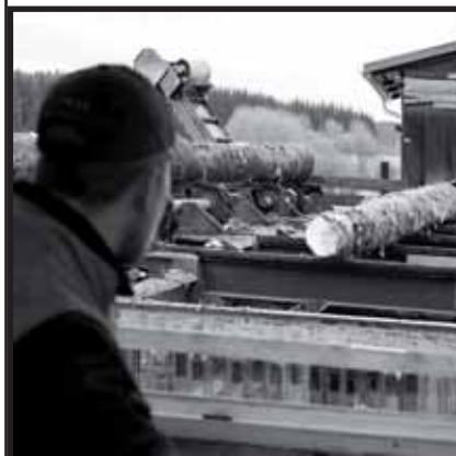
Première étape, l'écorçage des troncs d'arbre ou grumes (à savoir tronc ou portion de tronc couvert de son écorce). La scierie présente de moins en moins de manutention.
