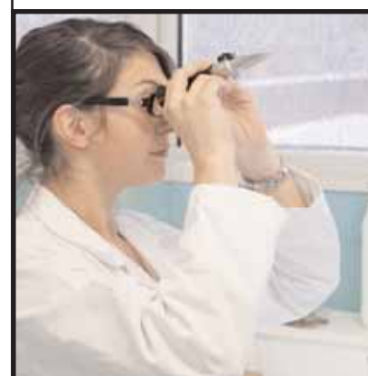
Le réfractomètre, instrument de contrôle des aliments.
